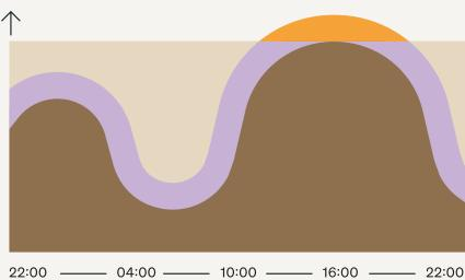
Wenn im Gebäude nur wenig Strom vorhanden ist, besteht die Gefahr, dass die Sicherung ausgelöst wird. Ein Elektriker würde die verfügbare Leistung reduzieren, um Stromausfälle zu vermeiden. Das bedeutet, dass Ihre Sicherung nicht ausgelöst wird, während Sie Ihr Elektrofahrzeug aufladen, aber es bedeutet auch, dass Sie den verfügbaren Strom nicht optimal nutzen werden.
